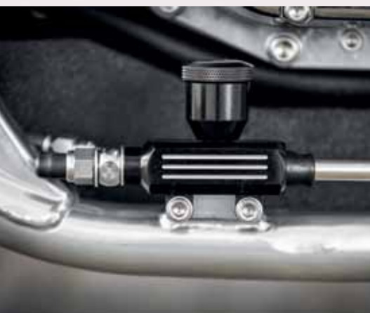
Der Öltank sitzt unterm Getriebe, auch die Bremspumpe ist neu konstruiert
