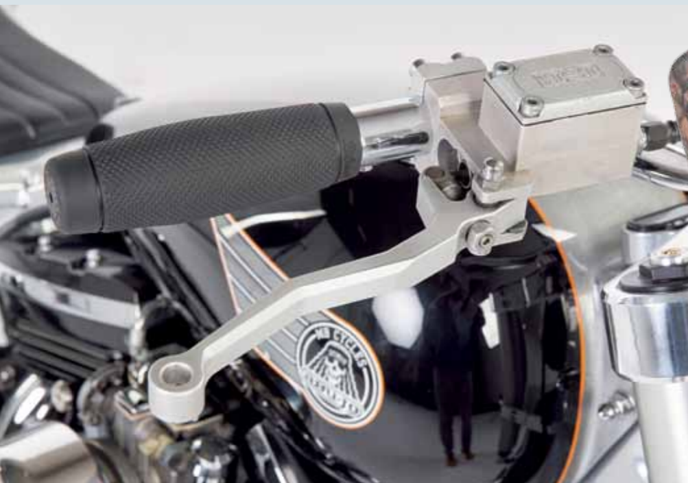
Versteckte Taster, innenliegender Gaszug: Becker-Bikes sind ultraclean!
