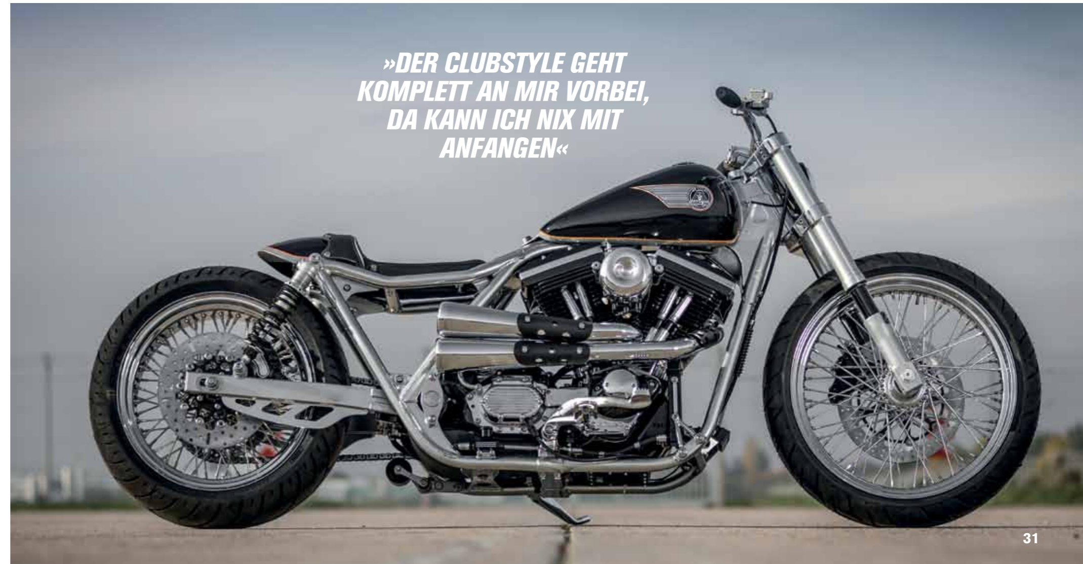
Fünf Rippen des V2 wurden weggefräst, der Motor ist außerdem komplett gemacht – 1584 Kubik und 100 PS, gemessen am Hinterrad, stehen zu Buche
