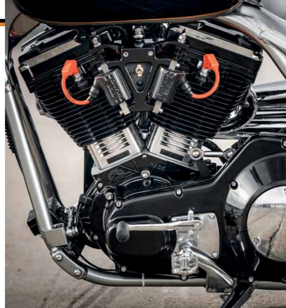
Fünf Rippen des V2 wurden weggefräst, der Motor ist außerdem komplett gemacht – 1584 Kubik und 100 PS, gemessen am Hinterrad, stehen zu Buche
