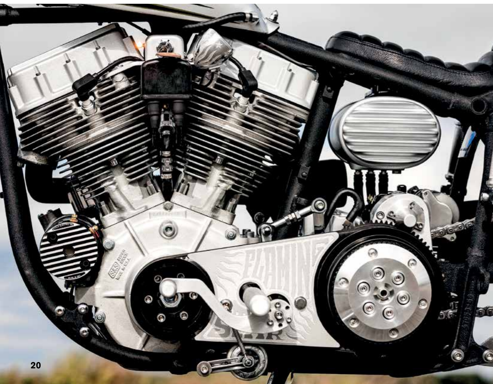
Macht er gern, der Martin: Als Kettenspanner fungiert eine Skateboardrolle (oben). Die sauberen Armaturen sind dank innenliegendem Gasgriff von Müller Motorcycles möglich. Der S&S-Panhead-Style-Motor war eine nicht ganz perfekte Basis und musste erst fit gemacht werden, inklusive Single-Fire-Zündung (unten)
